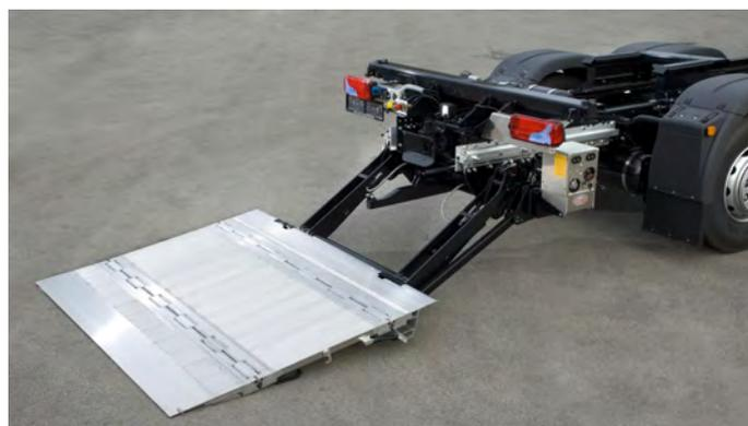
Dies ist eine perfekte und kosteneffiziente Konstruktion von Drei-Zylinder-Ladebordwänden, konzipiert für Klein-LKW's mit geringem Überhang und niedriger Ladehöhe.
