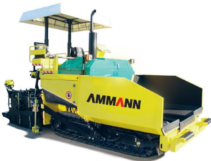
Der Kettenfertiger ist mit aufgeschraubten Gummilaufwerksplatt ausgerüstet und die Kettenspannung erfolgt über je einen Fettspannzylinder mit Stickstoffspeicher. Zwei Verstellpumpen und zwei zweistufige Hydromotoren mit Untersetzungsgetriebe bilden den vollhydrostatischen Antrieb. Die elektronische Steuerung erlaubt ein weiches Anfahren und Stoppen wie auch das genaue Einhalten der voreingestellten Geschwindigkeit.
