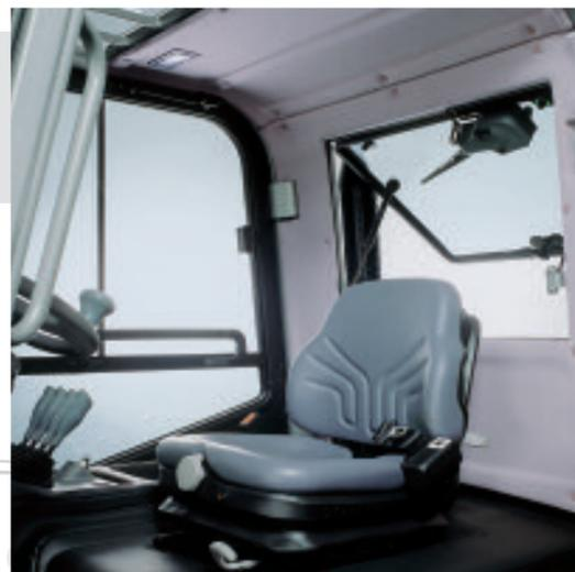
La nouvelle cabine complète, disponible en option, est montée à l'intérieur du profil de la protection. Elle est équipée, dans la configuration standard, de revêtements, d'accessoires et d'insonorisations soignées, de toit en lexan complet de gouttières, de verre coulissant et d'essuie-glaces à pantographe.
