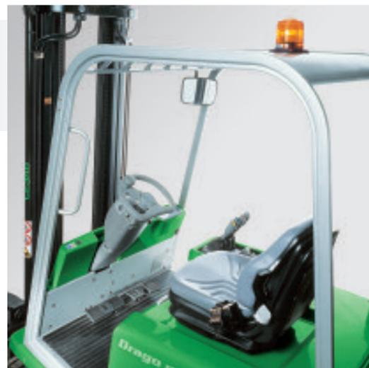
Le poste de conduite spacieux, facilement accessible grâce à la marche de montée, offre une excellente visibilité et s'adapte à tous les styles de conduite. La nouvelle colonne de direction est inclinée vers l'opérateur et d'un réglage facile pour augmenter le confort de conduite.
