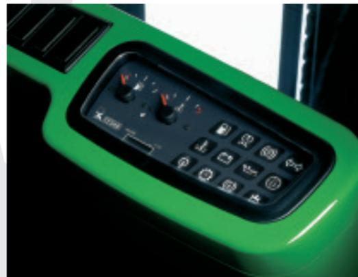
Le tableau de bord, style automobile, possède les voyants des principales fonctions ainsi qu'un écran pour l'identification rapide des codes défaut. De plus, nous avons un indicateur de position des roues arrière.
