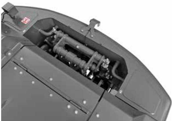
Instalacja przeciwpływa z przełącznikiem trybu automatycznego/ręcznego
