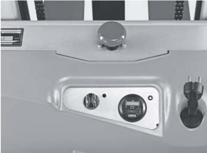
Todo siempre a la vista gracias a la pantalla LED con indicación de la carga de la batería y contador de horas de servicio
