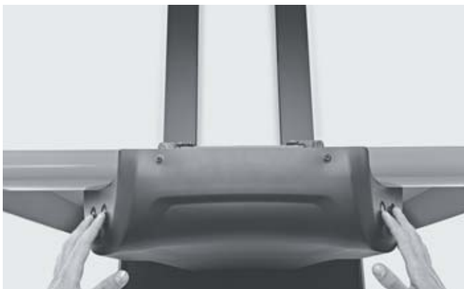
Bezpieczna obsługa oburącz mechanizmu dodatkowego podnoszenia
