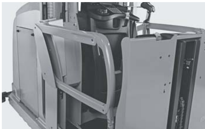
Rozkładana rampa do ergonomicznej kompletacji towarów nawet na końcu palety
