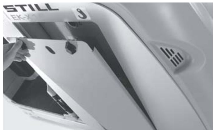
Крышку отсека АКБ легко открывать и закрывать без использования инструментов
