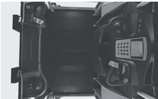
Двустороннее управление в кабине оператора
