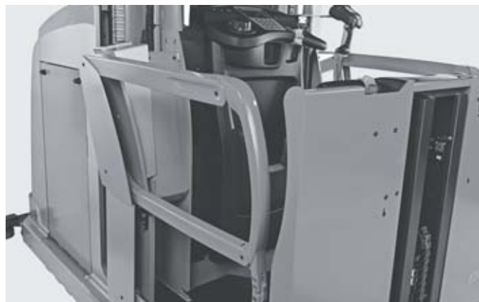
Наклонный барьер для эргономичного подбора грузов до конца паллеты
