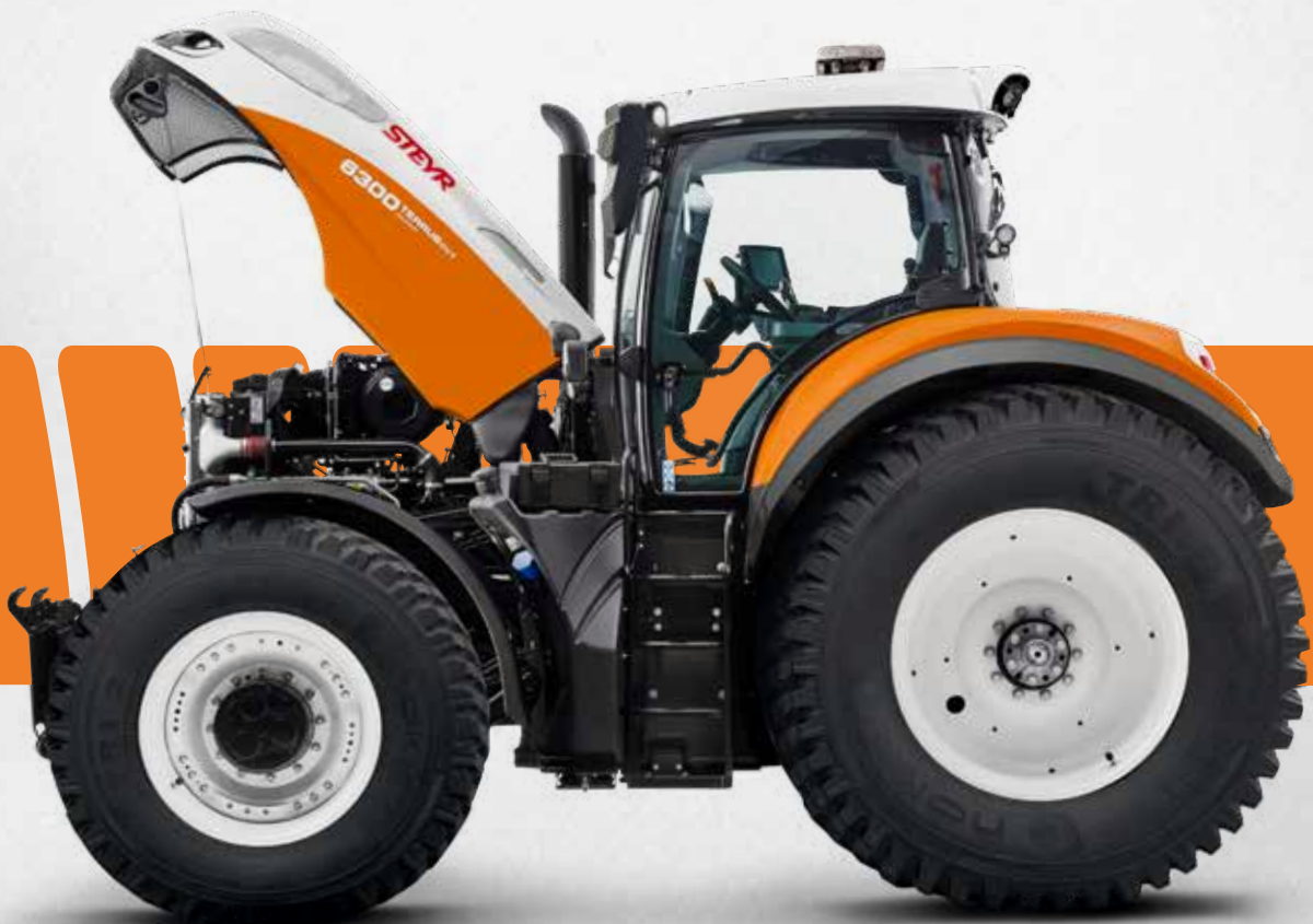
Kontinuierliche Reinigung über einen Piclon-Filter sorgt dafür, dass der Filter nur gewartet werden muss, wenn die entsprechende Warnleuchte angeht.
