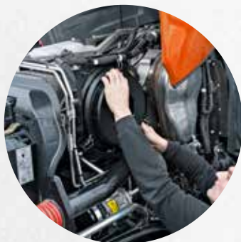
Kontinuierliche Reinigung über einen Piclon-Filter sorgt dafür, dass der Filter nur gewartet werden muss, wenn die entsprechende Warnleuchte angeht.
