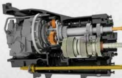
Stufenloses Getriebe von 0 bis 50 km/h
