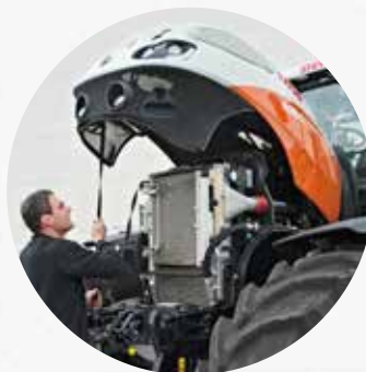
Einteilige, gasdruckgefederte Motorhaube kann in zwei Positionen angehoben werden (45°/90°), sogar mit angebaubtem Frontanbaugerät.
