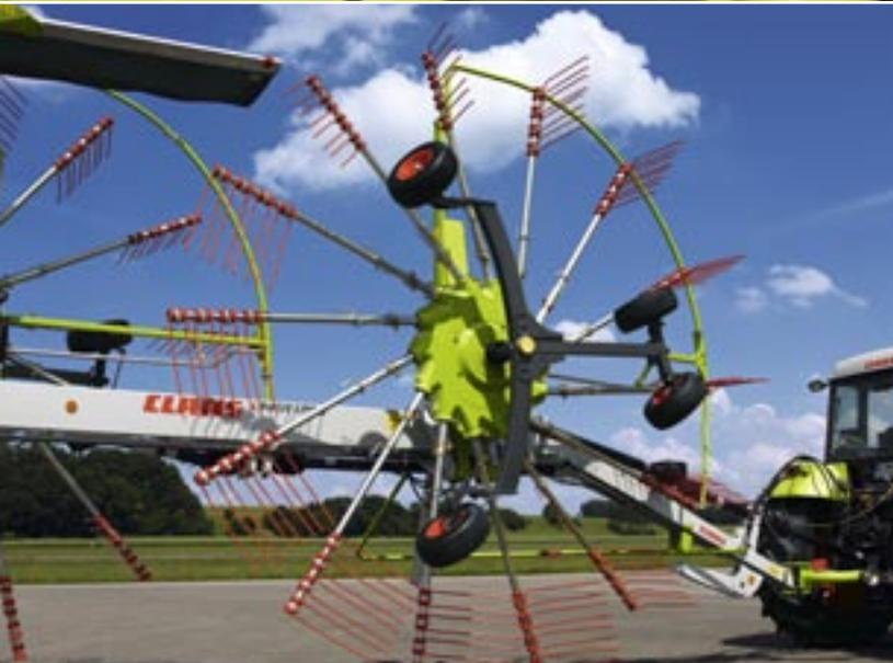
Rodada ancha con guía segura de los rotores – los chasis de 4 ó 6 ruedas para rotores.
