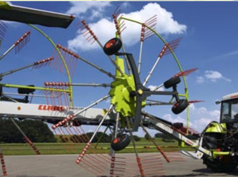
Carreggiata larga con guida sicura della girante: il carrello a quattro o a sei ruote.
