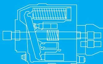
The use of a double pump with variable delivery together with a third gear pump permits the best exploitation of the power available / Der Einsatz von einer doppelten Pumpe mit unterschiedlicher Förderleistung mit einer dritten Pumpe mit Zahnrädern erlaubt die beste Ausnutzung der Druckkraft / Использование двойного насоса переменной нагрузки с 3-м насосом на шестеренках обеспечивает оптимальное потребление мощности
