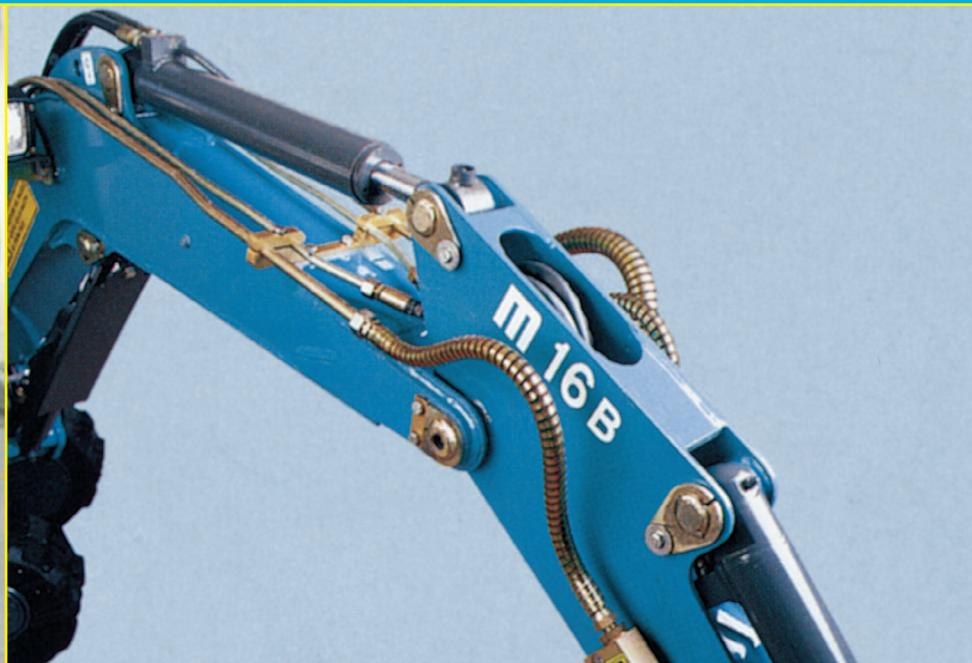
To grant maximum protection, the cylinder oleodynamic pipes of the bucket have been placed inside the arm / Für eine hohe Sicherheit, sind die öldynamischen Schläuche, vom Zylinder der Schaufel, im Innerem vom Arm / Для обеспечения максимальной безопасности, трубы гидравлической системы управления поршнем ковша проходят внутри плеча
