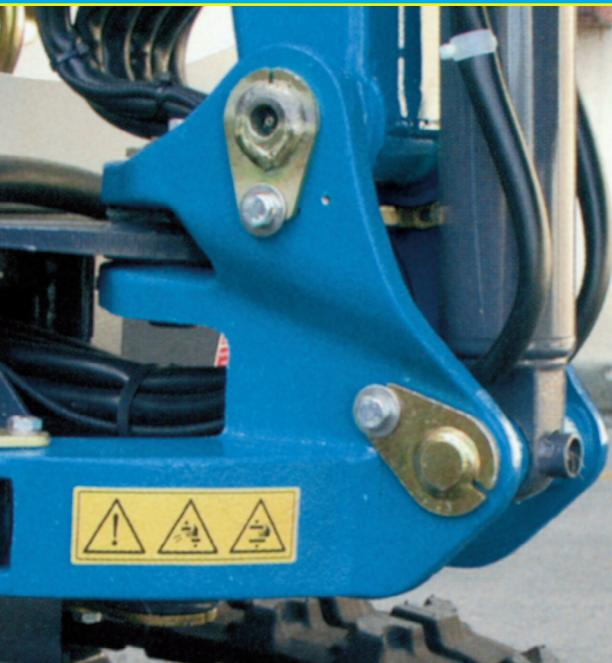
Details of the boom off-set articulation support, realized in a single spheroidal graphite iron casting / Detail vom Halter vom Armgelenk erzeugt in einer einzigen Ausschmelzung aus Sphäroguss / Изображение деркаталя шарнирного соединения роющего плеча, произведенного из единого сферомицального сплава чугуна.
