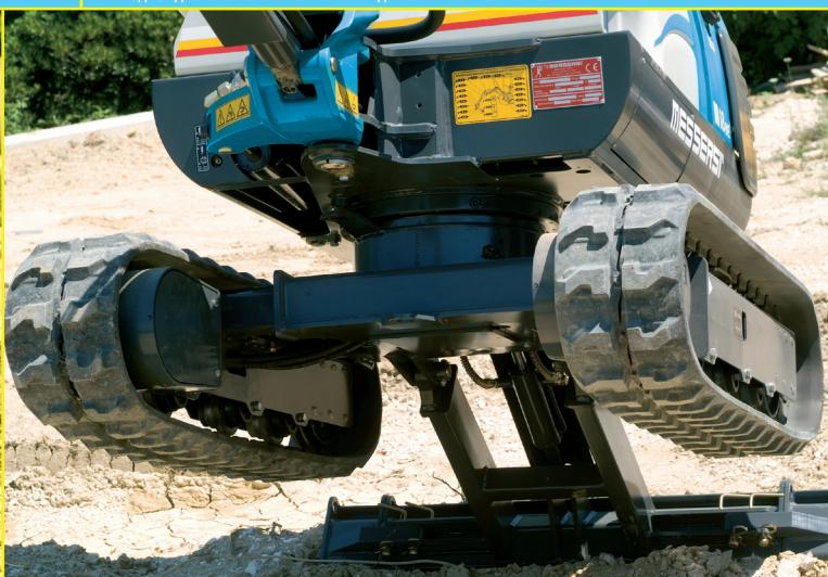
Hydraulic track widening from 1000 mm to 1300 mm (only M-18 BE), with a consequent manual adaptation of the refilling blade / Hydraulische Erweiterung der Raupenspur von 1000 mm bis 1300 mm (nur M-18BE), mit konsequenter Anpassung (manuell) an der neuen Breite vom Eingrabungsblatt / Гидравлическое расширение колеи от 1000 мм до 1300 мм (только в M-18BE), с последующей ручной регуляцией резака закапывания на новую ширину
