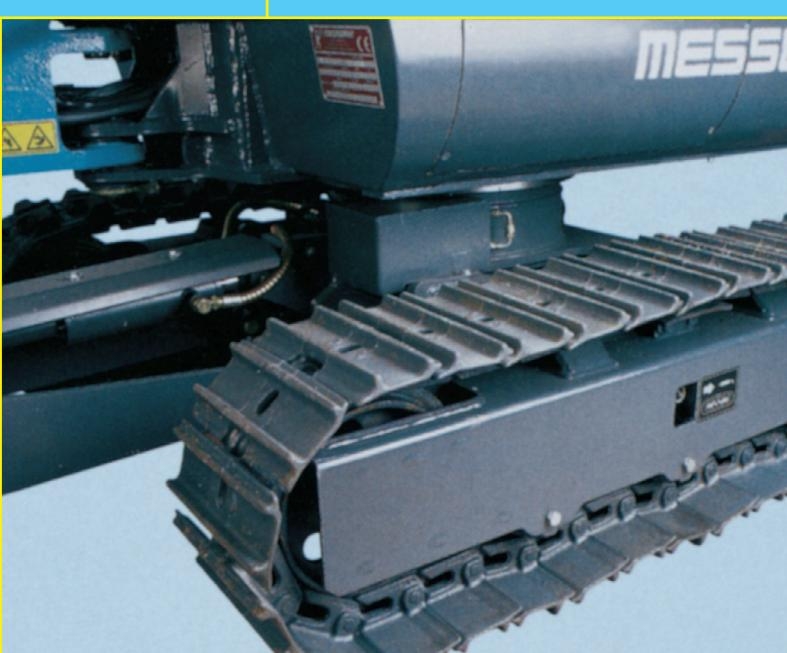
Models M-16BV and M-18 BE have interchangeable type rubber tracks, to allow also the use of steel tracks / Die Modelle M-16BV und M-18 BE haben auswechselbare Ketten - Gummiketten mit kurzen Ketengliedern und Stahlketten / Модели М-16BV и М-18 ВЕ производятся с резиновыми гусеницами взаимозаменяемого типа, поэтому ими могут быть использованы также и металлические гусеницы
