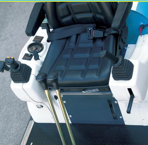
Details of the driving place with dashboard and servo-controls joystick / Detail vom Fahrersitz mit Armaturenbrett und Hebeln / Особенное место водителя с пультом и приводом
