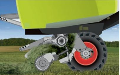
Potete inoltre equipaggiare la vostra VARIANT, sia ROTO FEED oppure ROTO CUT, con un fondo abbassabile mediante due cilindri idraulici. Il terminale di comando consentirà di eliminare eventuali ingolfamenti comodamente dalla cabina del trattore.
