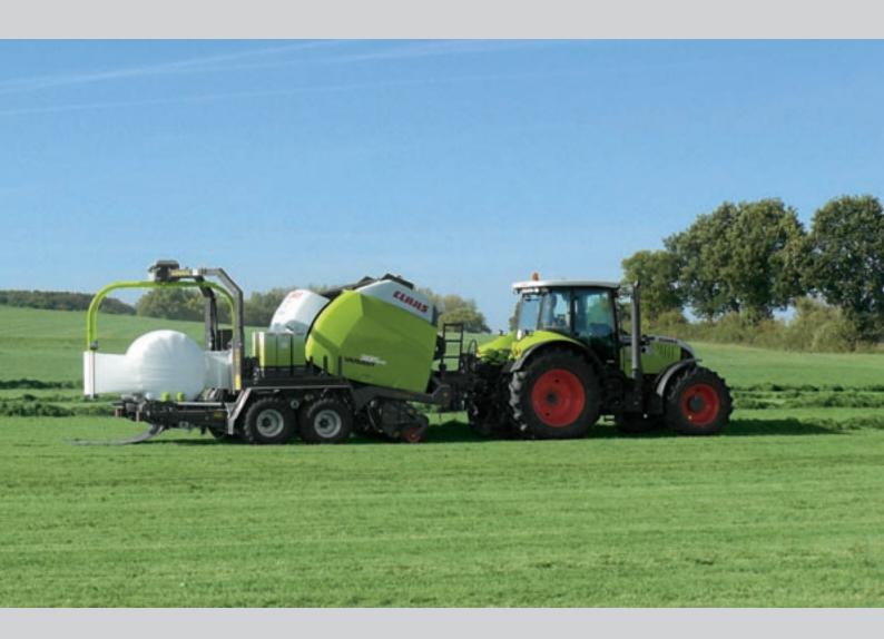
In combinazione con un avvolgitore è possibile sfruttare anche durante la raccolta dell'insilato le elevate prestazioni e la forte densità di pressatura della VARIANT.
