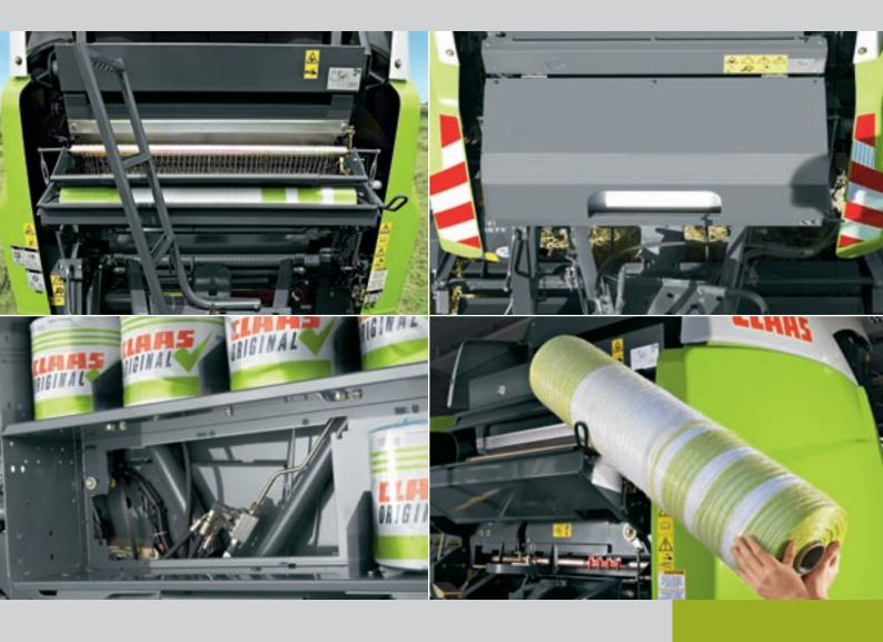
L'ampia apertura del carter di protezione offre un comodo accesso per la pulizia e la manutenzione.
